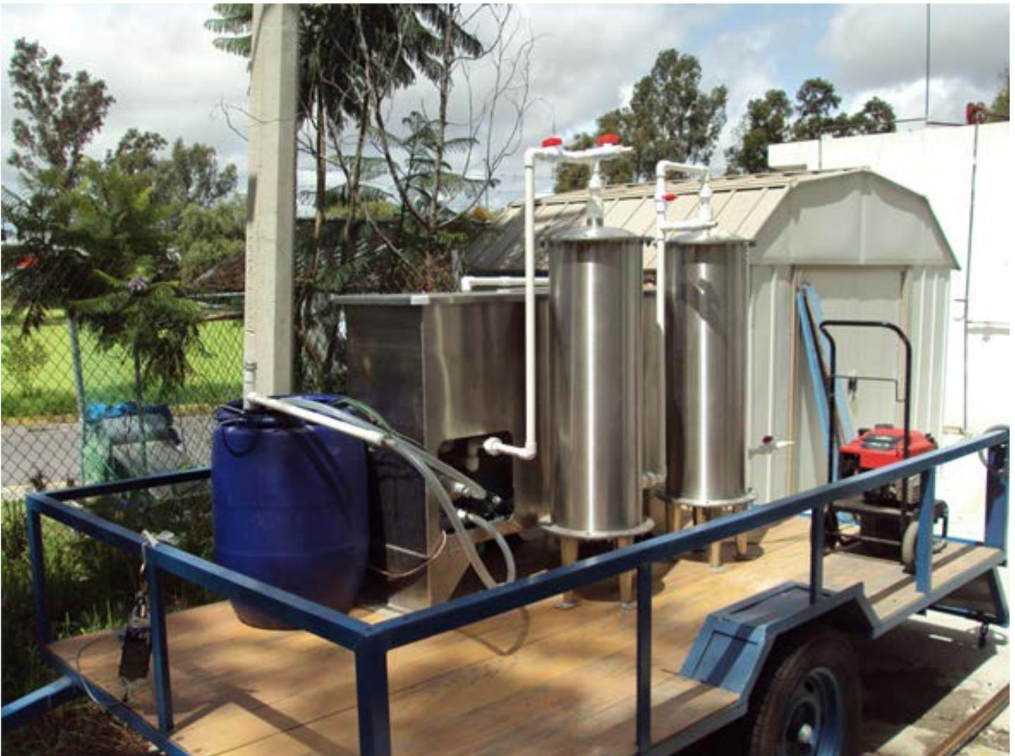
Figura 6. Vista lateral de la planta zeolítica, la cual contempla: a) generador de corriente eléctrica, b) inyección de los reactivos específicos para la coagulación-floculación, c) el intercambio de las especies iónicas y la filtración en carbón activado del agua contaminada.
