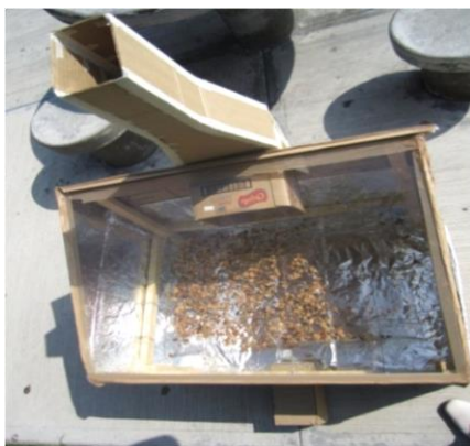
Figura 2. Colocación de la Cáscara de Naranja Dentro de la Cámara de Secado.
