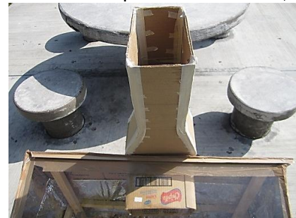
Figura 4. Salida de aire caliente y humedad.
