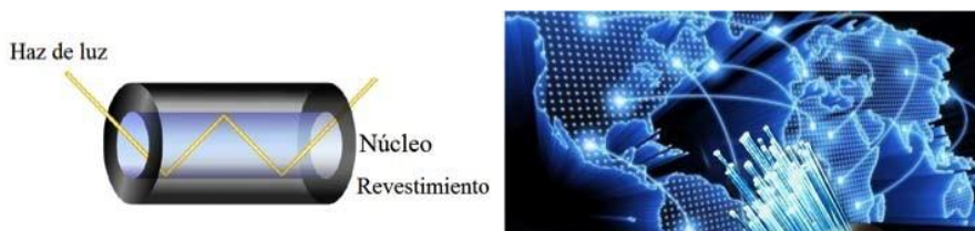
Figura 7. a) Diagrama esquemático de una fibra óptica, b) Aplicaciones de las fibras ópticas en las comunicaciones
