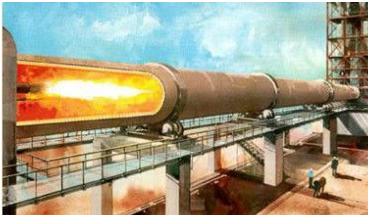
Horno Clinker usado en las industrias cementeras
