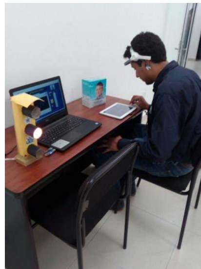
Figura 11. Aplicación del sistema para medir el nivel de atención de forma individual sin distractores.
